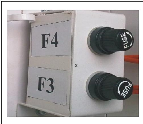
**Heater strip fuse F4 fan fuse F3**
